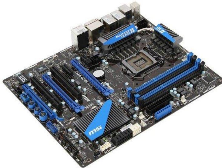
A Placa mãe aloja todos as peças do computador e é nela que todas as demais peças se conectam e transmitem suas informações. O Principal componente da placa mãe é o **Microprocessador**, o cérebro do computador.
